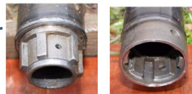
上杭(左)と下杭(右) 写真は施工後に引き抜いた杭
